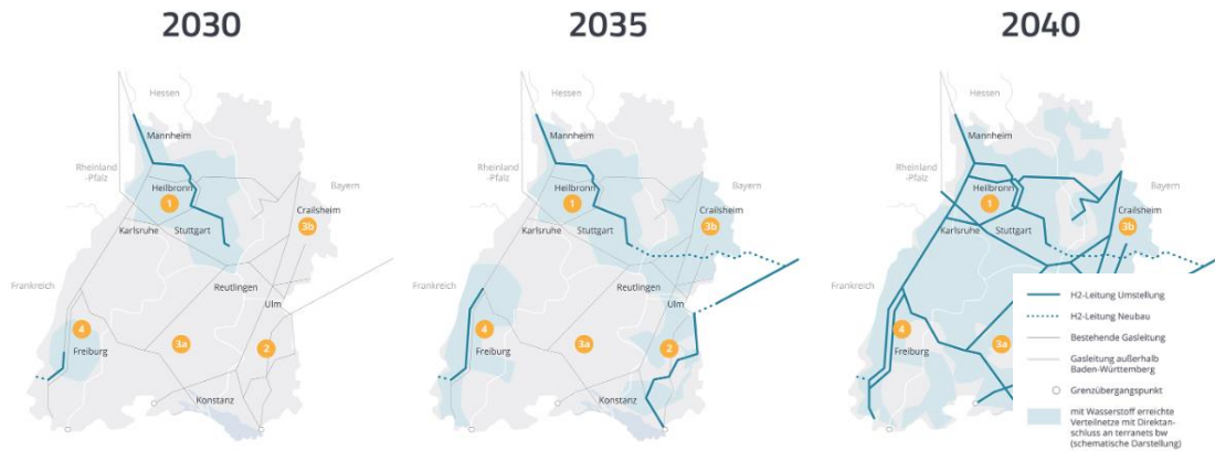
Abbildung 28: Darstellung schrittweiser Ausbau der Süddeutschen Erdgasleitung für die künftige Versorgung von Wasserstoff in Baden-Württemberg [25]
